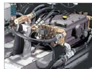
BOMBA DE PISTÃO DE ALTA PRESSÃO COM 6 PISTÕES EM CERÂMICA DE 2 CABEÇAS EM BRONZE
